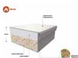
installationsgulv med gulfplader med kerne i calciumsulfat/træ og overflade i galvaniseret stål, 0,5 mm
