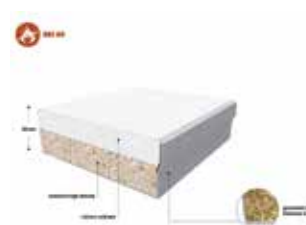
installationsgulv med gulfplader, kerne i caliumsulfat/træ, halvindkapslet i stål
